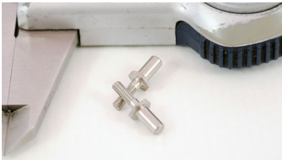
Spe. skrue M3x12 NV10 med lejepasning Ø5
